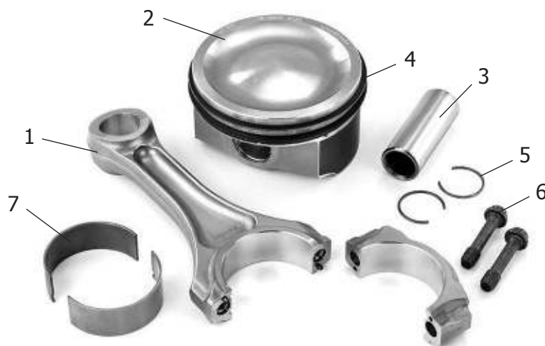
Зураг 25. Шатун поршенгийн групп 1-шатун түүний эрүү 2-поршен 3-хуруу 4-поршенгийн бүс 5-хурууны түгжээ 6-шатуны эрүүний боолт 7-гулсах холхивч
