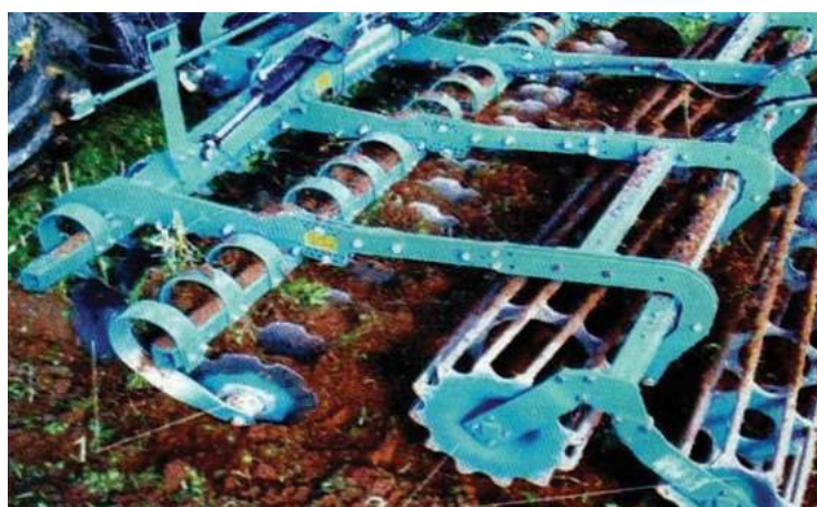
Зураг 3. Ургамлын үлдэгдлийг хөрстэй холих, хөрсийг нунтаглах давхар цан (1), хөрс нунтаглах, нягтруулах ташуур байрлалтай трубан бул (2)
