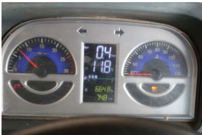
Зураг 16. Тракторын хянах самбар Тракторын хянах самбар дээр байгаа 0.4 мПа нь тосны даралтын хэмжээг заана.
