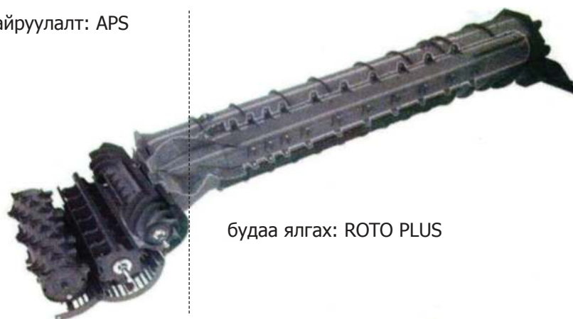
Зураг 8. CLAAS загварын комбайны цайруулах APS, сүрлээс будааг ялгах ROTO PLUS <<эрлийз>> систем
