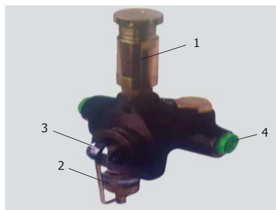
Зураг 37. Шахах насос: 1-гар насос, 2-түлшний шүүр, 3-нударган голоос хөдөлгөөн авах түлхэгч, 4-түлш дамжуулах хоолой холбогдох хэсэг
